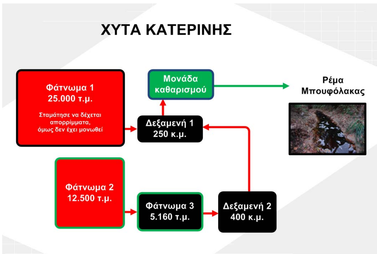
Το διάγραμμα των εγκαταστάσεων του ΧΥΤΑ Κατερίνης με την ροή των στραγγιδίων από τα φαντώματα προς τις δεξαμενές και τον μηχανισμό καθαρισμού.
